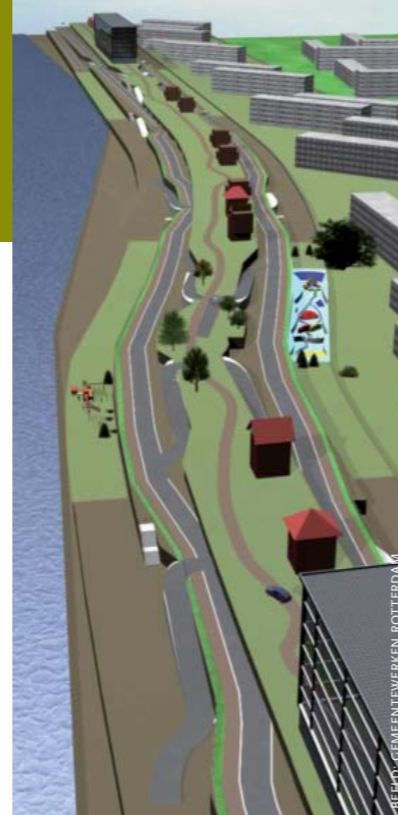
De 'treden' van de nieuw ontwikkelde trapdijk zijn te gebruiken voor wegen, groen, bebouwing, parkeren, waterberging en andere functies.
